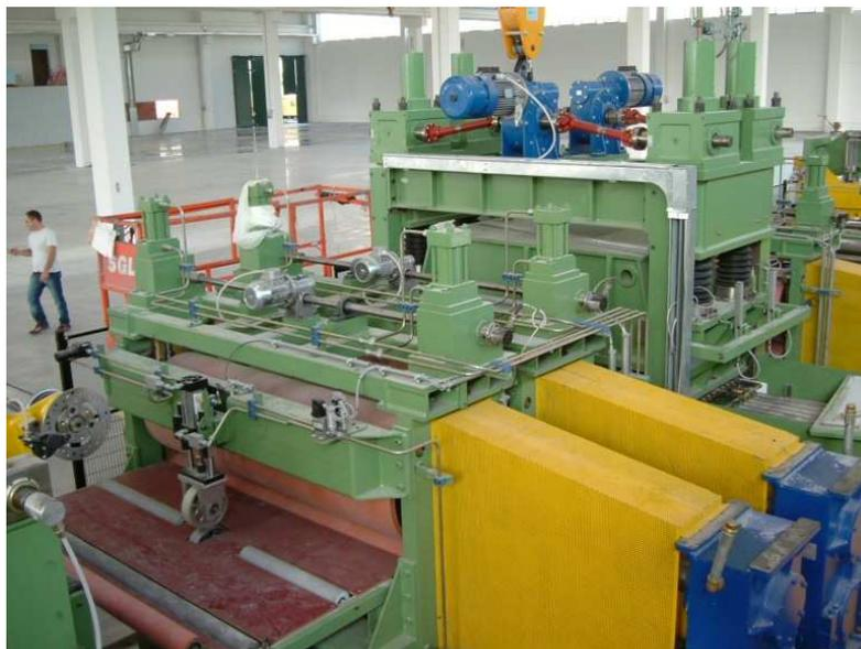
Linea tensionatura con sistema di scarto automatico
